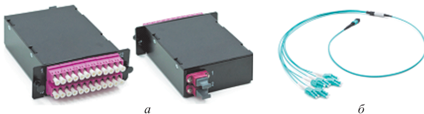
Рис. 2. Интерфейсные средства между разъемами МРО и LC или SC: а — кассета 2×МРО(12) — 24×LC, OM4, 24-портовая (вид спереди и сзади); б — fanout-сборка 1×МРО(12) — 12×LC, OM3
