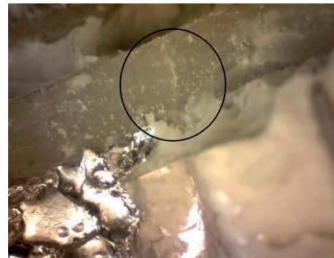
Рис. 4. Изображение трещины
