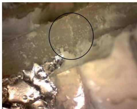
Рис. 4. Изображение трещины в пластине при креплении ее к корпусу пайкой
