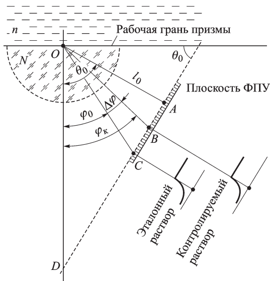
Рис. 6. К определению зависимости линейного смещения в плоскости ФПУ от критического угла
