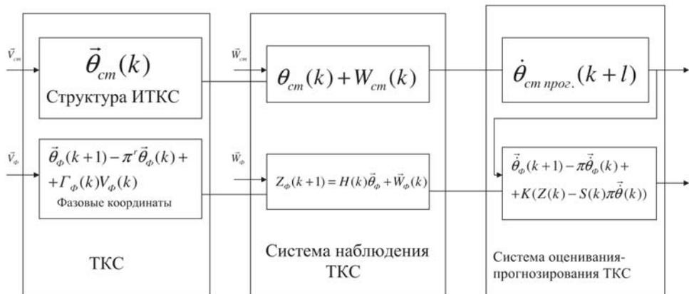
**Рис. 1.** Общая схема системы наблюдения–оценивания–прогнозирования значения ТКС
