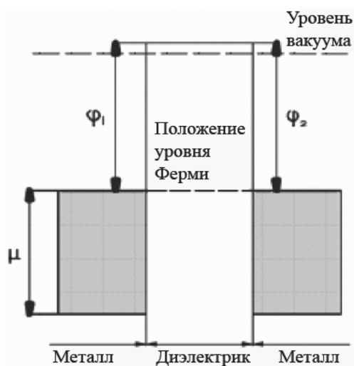
Рис. 1. Энергетические уровни в системе “Металл–диэлектрик–металл” в состоянии равновесия при отсутствии смещения
