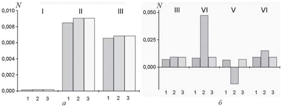
**Рис. 1. Определение концентраций газовых компонент трехкомпонентной (а) и шестикомпонентной (б) смеси**
