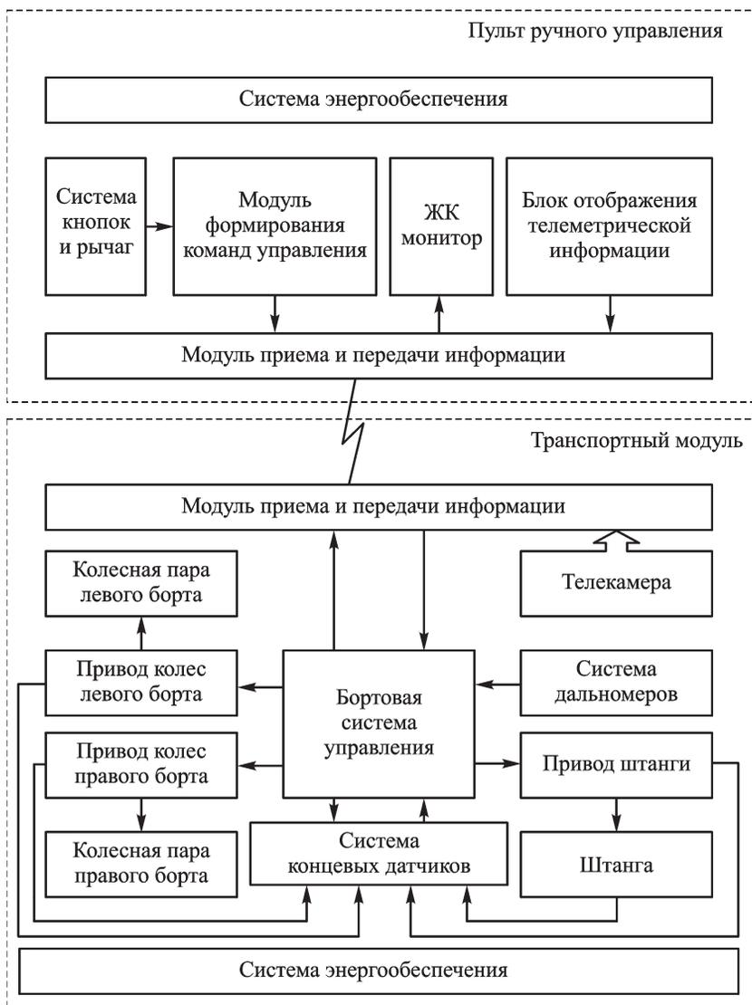
**Рис. 3. Структура системы управления ЛРР**
