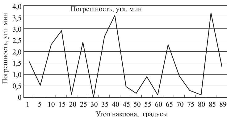
Рис. 4. Расчет погрешности определения углов системы позиционирования
