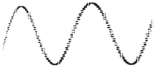
Рис. 13. Оциллограмма синусоиды 1 кГц на выходе параллельного ЦАП без интерполяции и аналоговой фильтрации
