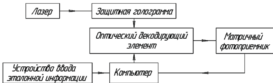
Рис. 1. Структурная схема опико-электронного устройства идентификации ЗГ с точки зрения разделения на конструктивные элементы
