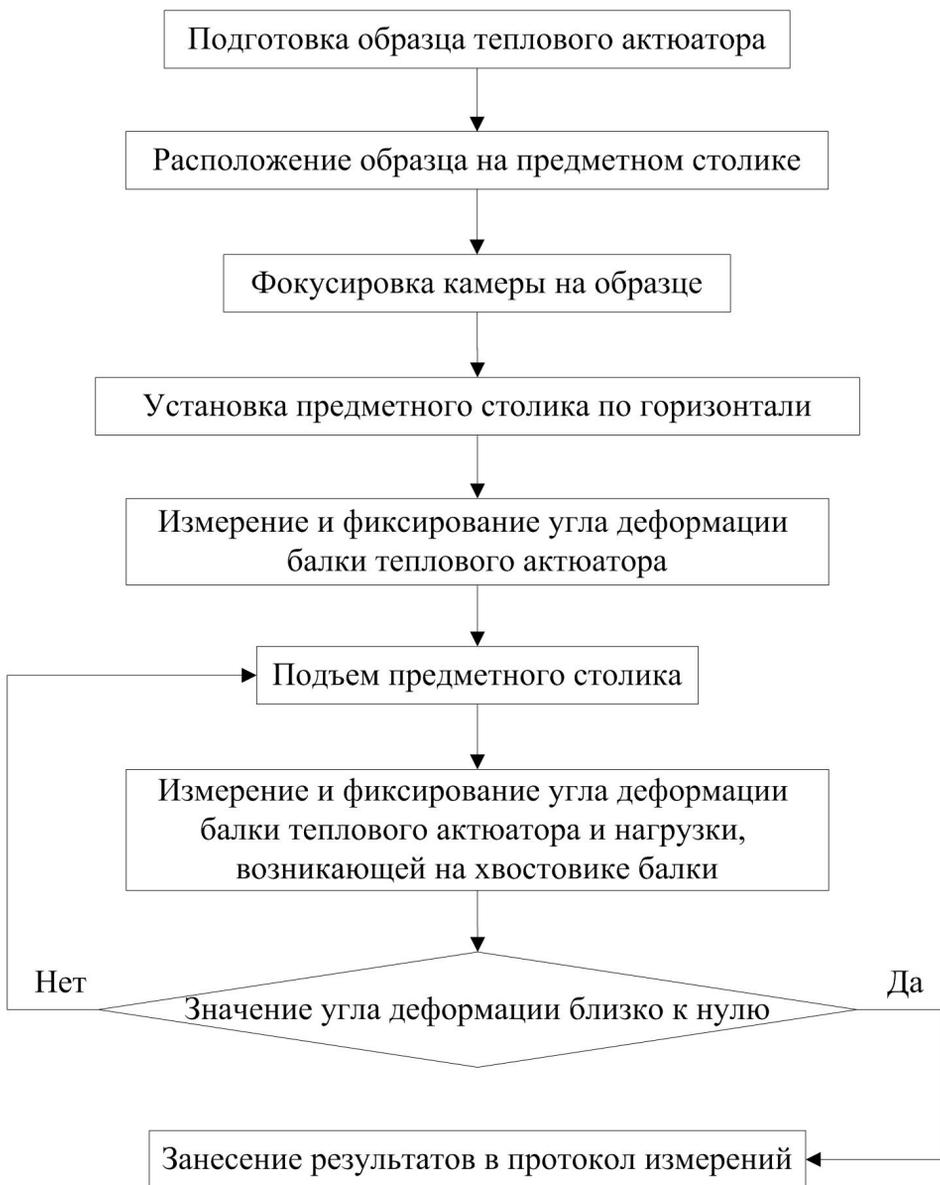
**Рис. 3. Алгоритм проведения измерений силовых характеристик балок тепловых микроактюаторов**
