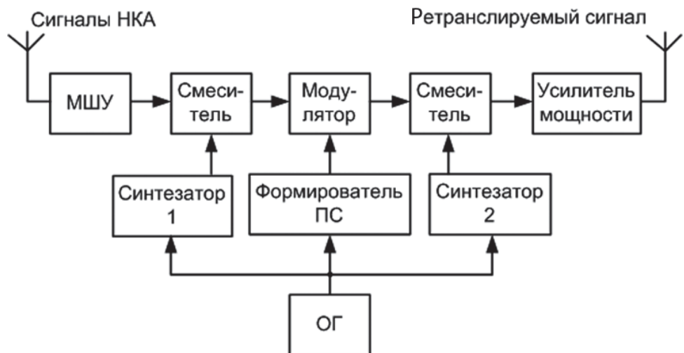
Рис. 1. Структура ретранслятора с МПС
