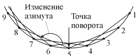
Рис. 6. Коррекция азимутальных показаний по данным цифровой карты
